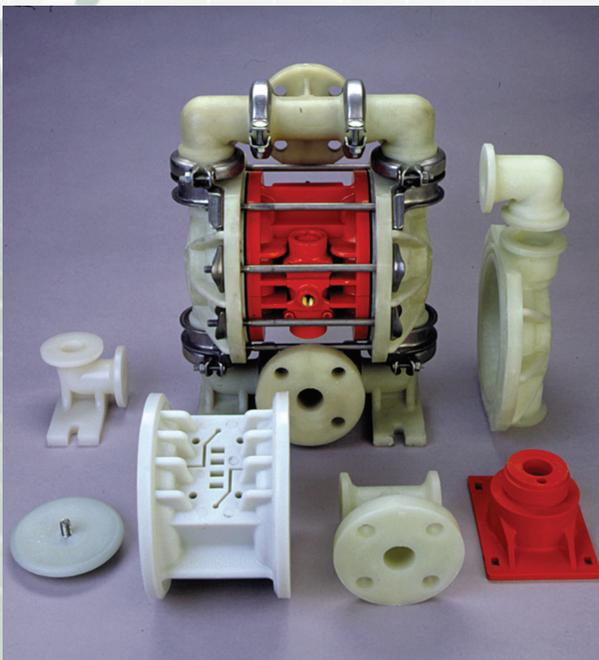
液体ハンドリングポンプの部品には、耐薬品性のあるRTP製ガラス繊維/ポリエチレン化合物を使用すると、腐食や劣化を防止。この特殊コンパウンド材料を使用したポンプは18ポンド(約8.2kg)と軽量化に成功、金属での同製品重量は42ポンド(約18.5kg)にもなります。更に、表面仕上げの二次加工の工程も省略。
