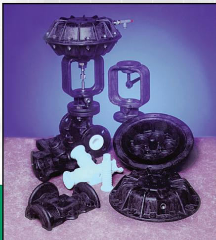
高圧流体に適したこのプラスチック制御弁は、腐食を完全防止するうえ、同様の金属弁に比べ重量を半分未満に低減できます。ボンネット、空圧式アクチュエータ、T字継手など、あらゆる黒色部品がRTP 4000シリーズ強化PPAの特殊コンパウンド材料で成形されています。シェルとコアの設計により、極めて優れた強度と耐衝撃性を備え、過剰な熱や圧力が加わっても、白色PTFE部品のクリーブ損傷が発生しません。
